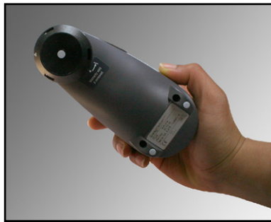
Positionierung des Gretag Macbeth Eye-One pro zur Umgebungsmessung.
