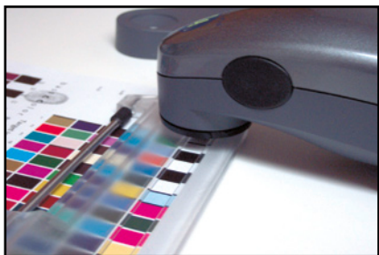
Das Eye-One pro Messgerät muss im weißen Bereich vor dem ersten zu messenden Farbfeld positioniert werden, um den Streifen korrekt zu erkennen.
