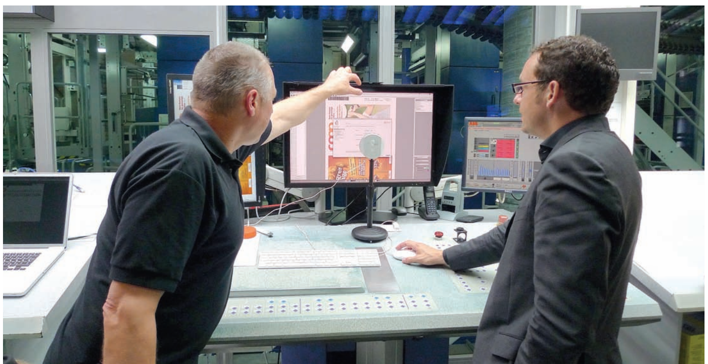
Monitorkalibrierung: Die Telemessung (Messgerät in der Bildmitte) entspricht der Art und Weise, wie das menschliche Auge einen Bildschirm betrachtet.
