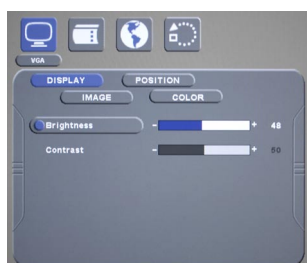
Helligkeitseinstellung: Brightness Mittelstellung: ergibt ca. 130 cd/m 2 bei D50
