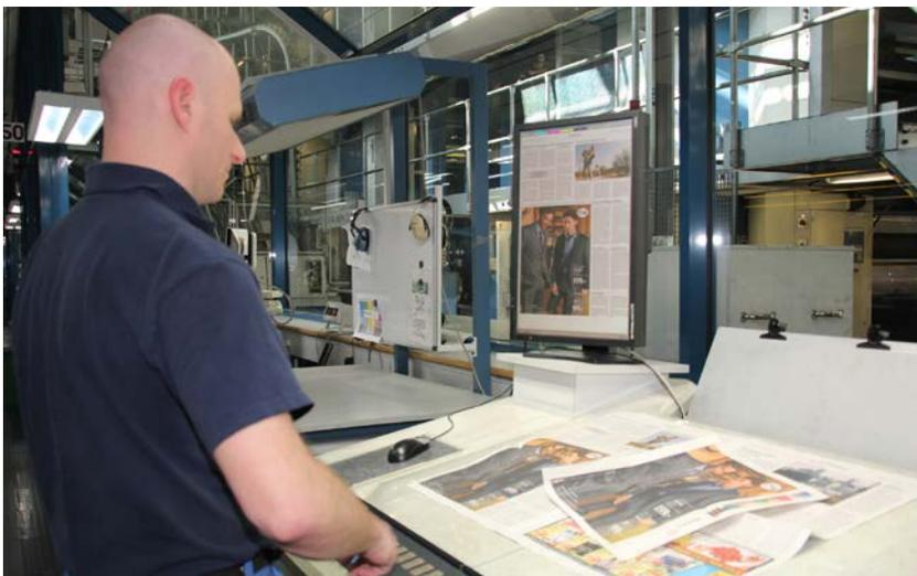
Abbildung B-75: Beim Zeitungsdruck wird die Monitorproof-Abmusterung oft bei voller Beleuchtungsstärke vorgenommen. Der beim Coldset-Rollenoffsetdruck auf Zeitungspapier vergleichsweise niedrige Farbumfang erlaubt die dazu erforderliche hohe Monitor-Leuchtdichte.
